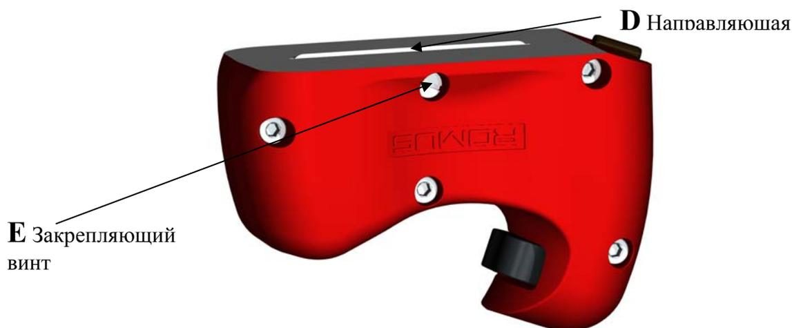
1. Отвинтить закрепляющий винт (Е).
