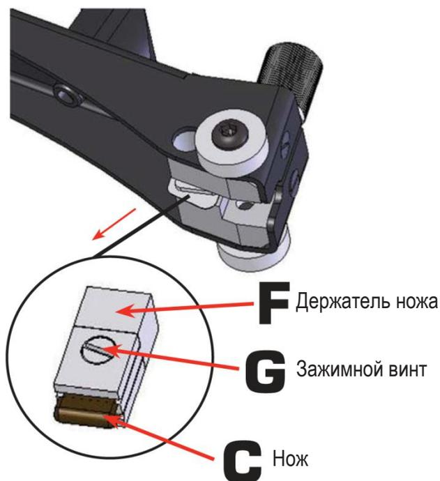
1. Опускайте нож, вращая регулировочный винт с накаткой (А), пока он проворачивается свободно.
