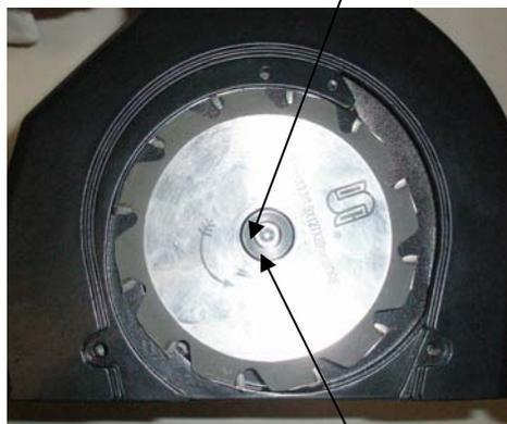
Вал режущего элемента
