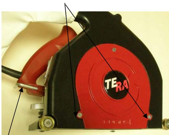
Воспользовавшись ключом из комплекта, отвинтите винт крепления режущего элемента.
