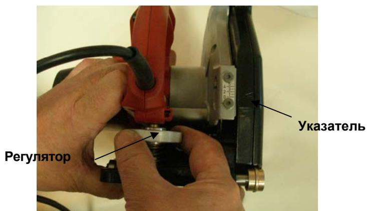
Проведите пробную резку на ненужных обрезках материала.
